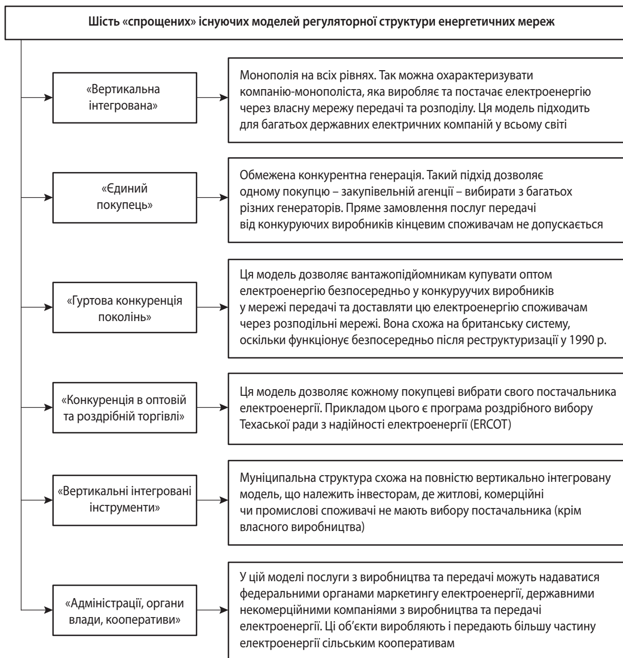
Рис. 2. Шість «спрощених» існуючих моделей регуляторної структури енергетичних мереж
